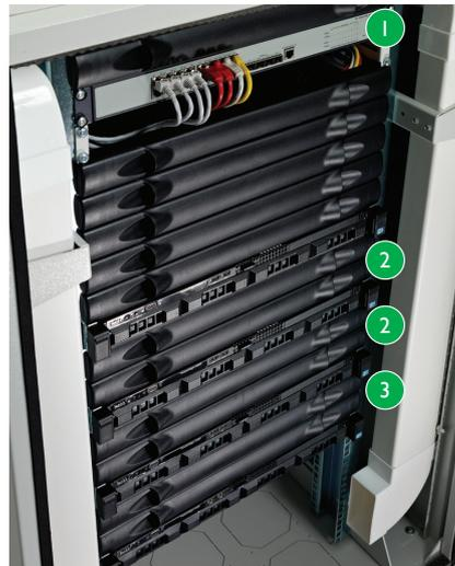
Opciones de armazón basado en rack normalizado con control de temperatura.
