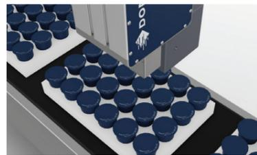
Spezial-Scankopf für große Markierungsfelder und breite Bahnanwendungen.
