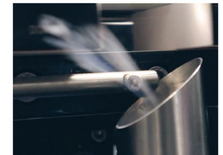
Die Domino **DPX-Laserabsaugsysteme** filtern Rauch und partikelförmige Verunreinigungen effektiv aus dem Codierprozess.
