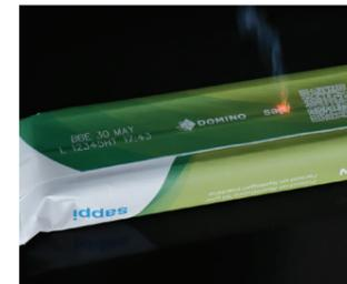
**Papierbasierte Umhüllungen:** Kennzeichnungsalgorithmen, die sanft genug sind, um moderne, nachhaltige Verpackungsmaterialien zu codieren und gleichzeitig die Schutzbarrieren intakt zu halten.
