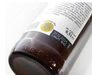
**Papieretikett:** Kennzeichnung von Glasflaschenetiketten bei Geschwindigkeiten von bis zu 70.000 bis 90.000 Flaschen pro Stunde.
